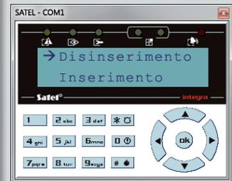
La tastiera virtuale messa a disposizione dal software è un ulteriore vantaggio poiché permette di accedere a tutte le funzioni della centrale, come se si fosse fisicamente davanti alla tastiera convenzionale.
